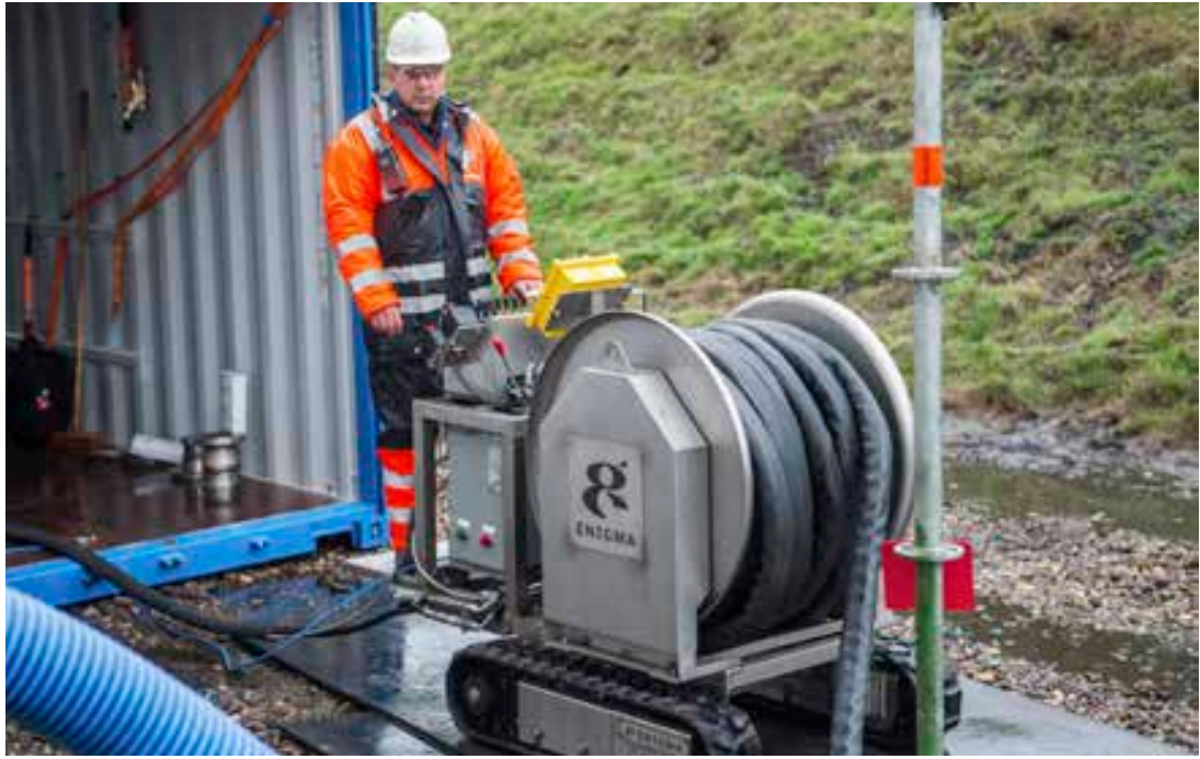
De robot wordt van buiten de opslagtank bestuurd.
